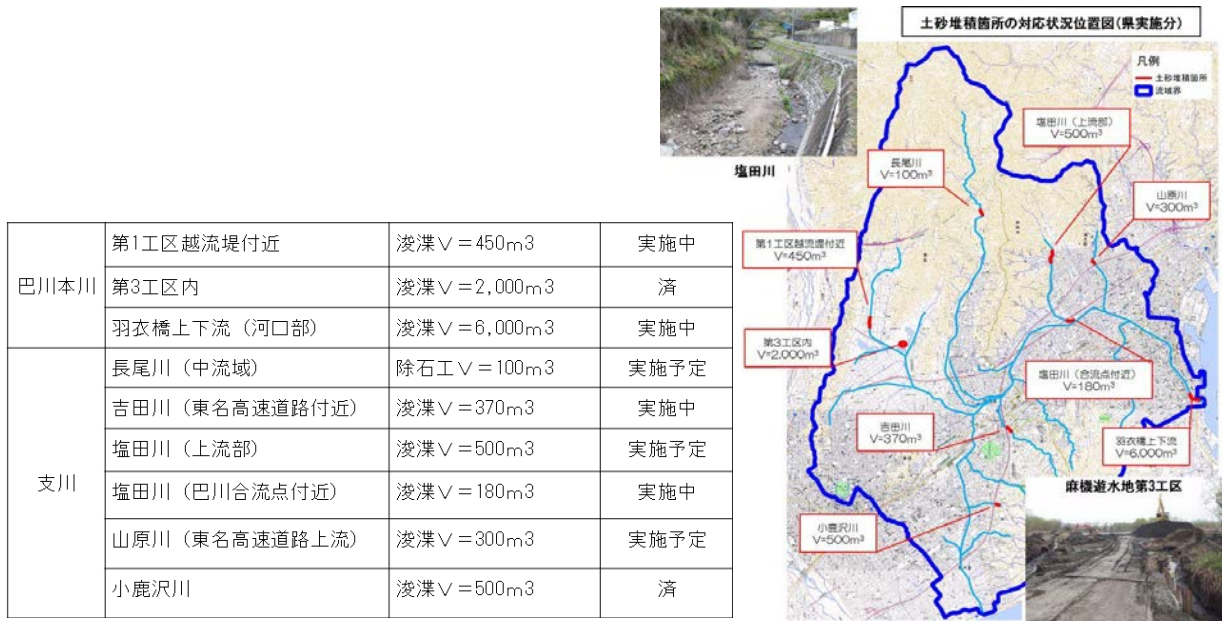
図 4-7 県による土砂浚渫実施状況
